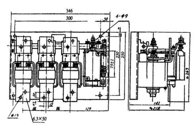
6 CKJ5-630/1.14 接触器外形及安装尺寸图
